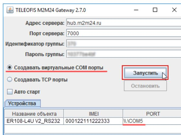
Рис. 18. M2M24 Gateway. Запуск виртуальных COM-портов.
