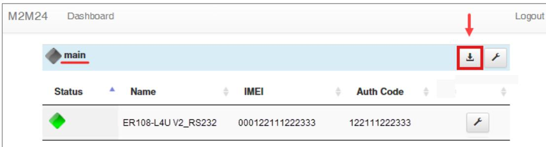
Рис. 11. Загрузка файла конфигурации с сервера M2M24 Cloud.
