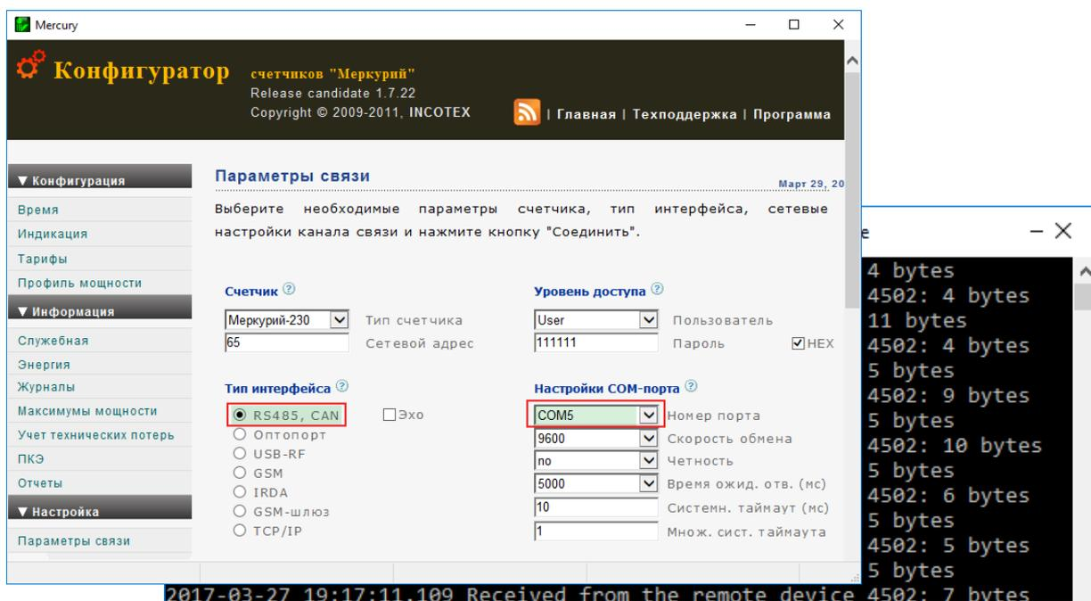
Рис. 19. Настройка подключения «Конфигуратор Меркурий» к серверу M2M24 (COM-порт).
