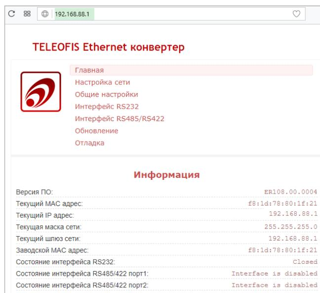
Рис. 5. Веб-интерфейс для настройки конвертера ER.
